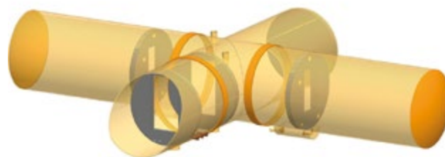
Mehrkammersystem mit zwischengeschalteter Schieberkammer
